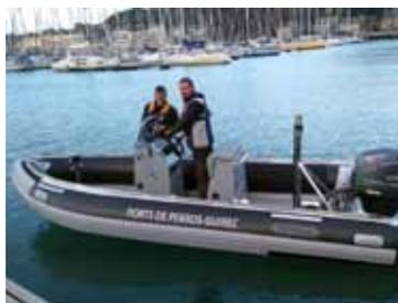
Ce navire semi-rigide de 5,60 m est équipé de deux mats de remorquage et d'un moteur de 80 cv. Polyvalent, il permettra aux agents portuaires de réaliser dans de meilleures conditions les missions d'accueil, de remorquage, de contrôle des installations et d'interventions urgentes sur les zones de mouillages. Ce nouvel investissement s'inscrit dans une volonté d'améliorer les services offerts aux usagers des ports et de séduire de nouveaux prospects.
