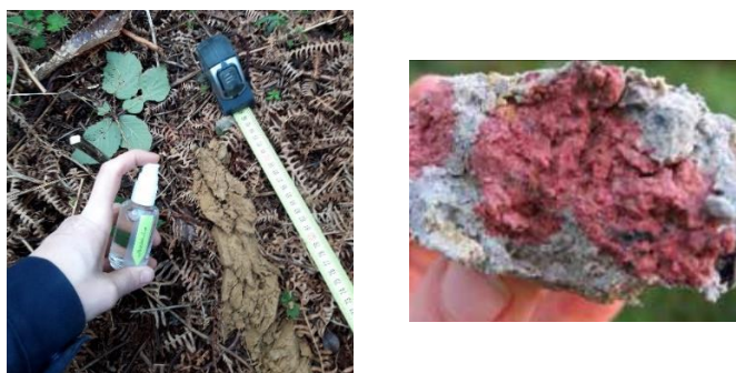
Figure 4 : Emploi de la phénanthroline et réaction associée en présence de Fer
