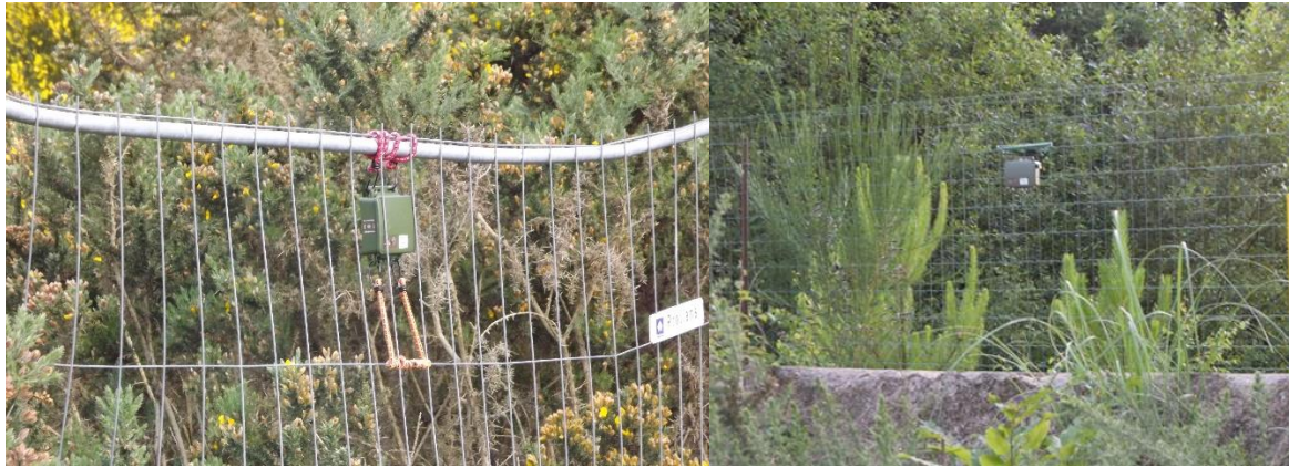
Figure 15 : Song Meter Mini Bat pour l'enregistrement des chiroptères
